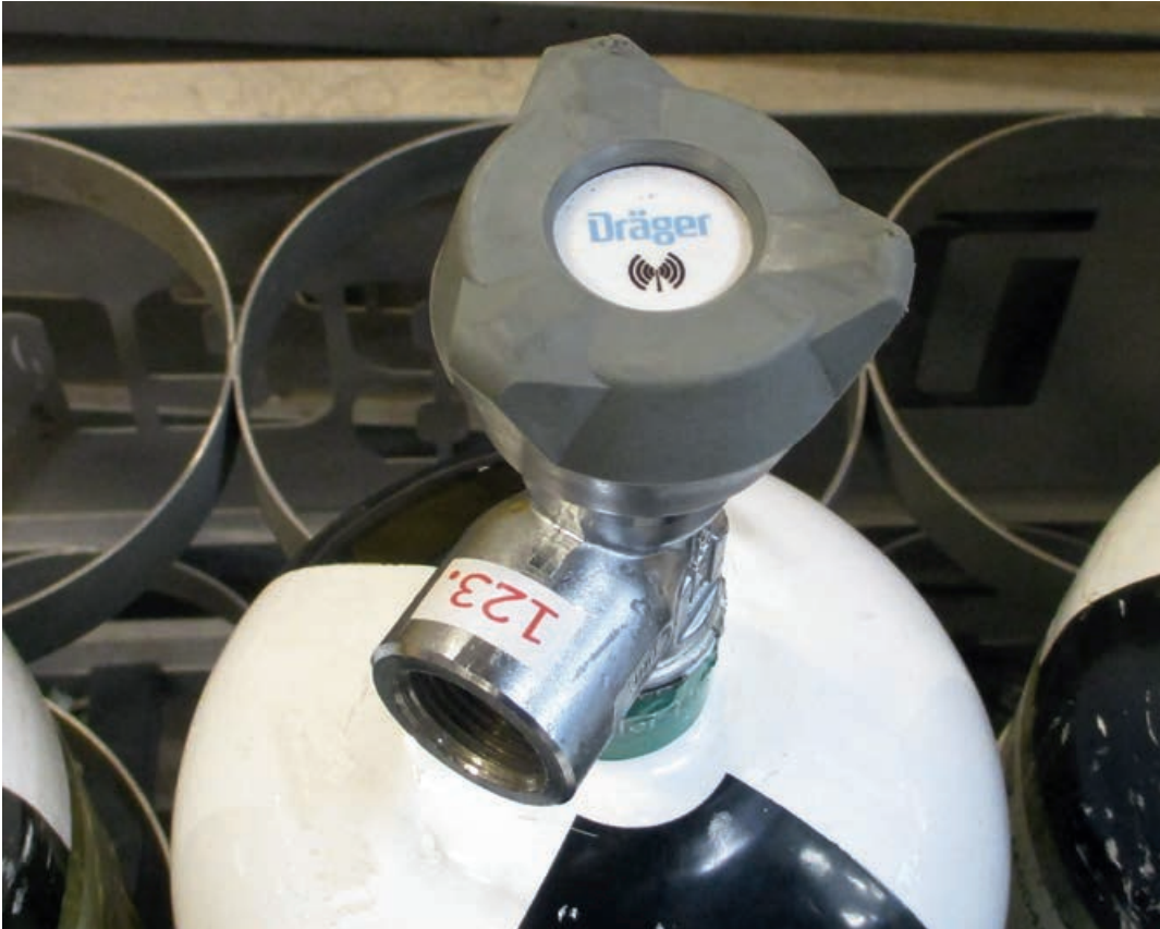
Transponder verwerkt in handwiel
