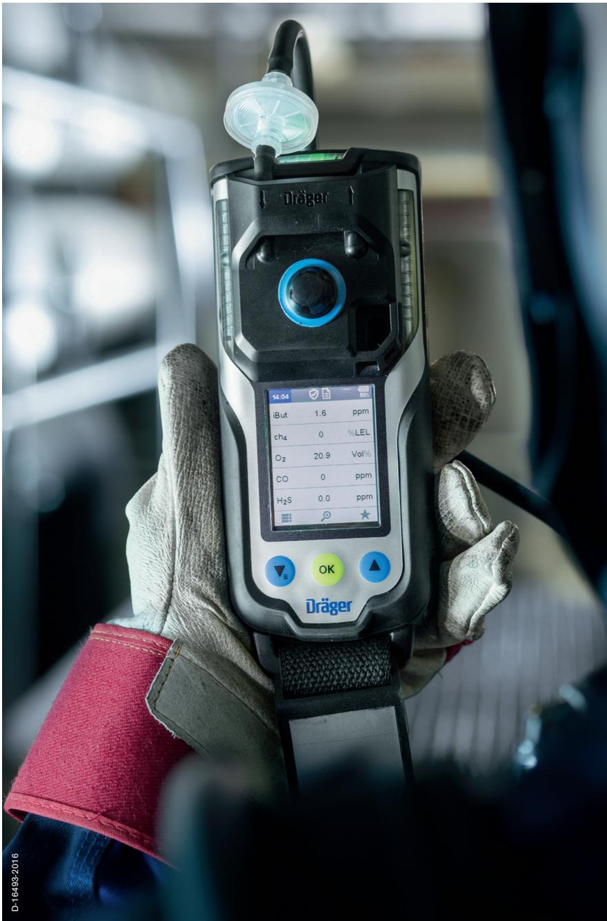
Treten in einem Arbeitsbereich verschiedene Gefahrstoffe (Ex-Ox-Tox) auf, so empfiehlt sich der Einsatz von kontinuierlich messenden Mehrgasmessgeräten. Sie bieten die Möglichkeit, unterschiedliche Messprinzipien (Infrarot-, Wärmetönungs-, PID- und elektrochemische Sensoren) in einem Gerät und somit die jeweiligen Stärken der Messprinzipien zu nutzen.
