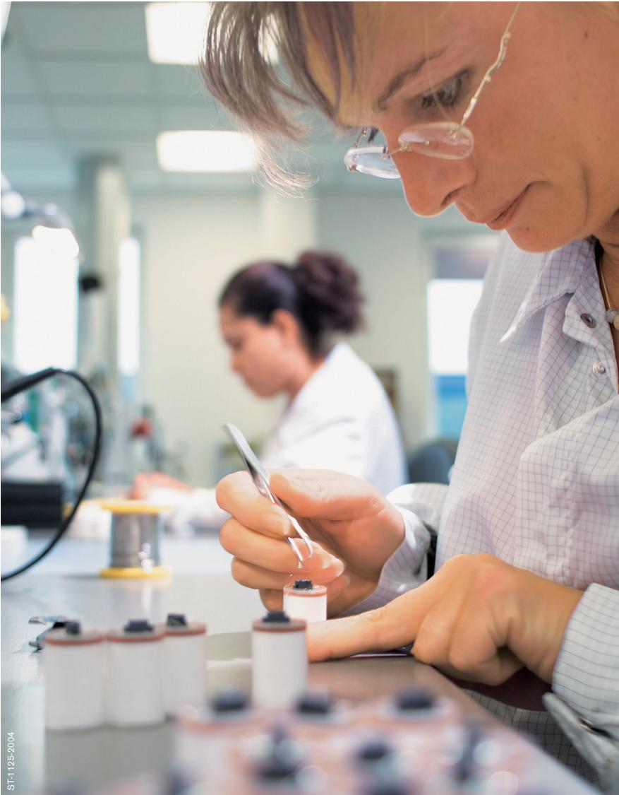
Viele toxische Gase sind auch sehr reaktiv und lassen sich unter geeigneten Bedingungen chemisch umsetzen. Der elektrochemische Sensor ist ein Mikro-Reaktor, der bei Anwesenheit solcher Gase einen sehr geringen, aber messbaren Strom erzeugt. Wie bei einer Batterie ist hier Elektrochemie im Spiel, denn die chemische Umsetzung produziert Elektronen.
