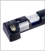
Die Dräger Bump Test Station erleichtert den arbeitstäglichen Begasungstest, da die Bewertung des Tests durch die Geräte selbst vorgenommen und das Prüfgas beim Einlegen automatisch aufgegeben wird. Weiterhin sind die meisten Geräte in der Lage, die Station automatisch zu erkennen und somit ohne manuelle Einwirkung in den Begasungstest-Modus zu wechseln.
