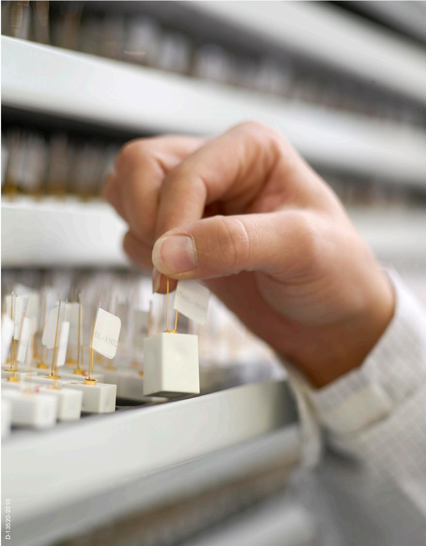
Unter gewissen Umständen kann man brennbare Gase und Dämpfe unter Freisetzung von Reaktionswärme mit Luftsauerstoff oxidieren. Hierzu verwendet man geeignetes temperiertes Katalysatormaterial, das sich durch diese Reaktionswärme zusätzlich messbar erwärmt. Diese geringe Temperaturerhöhung ist ein Maß für die Gas-konzentration.
